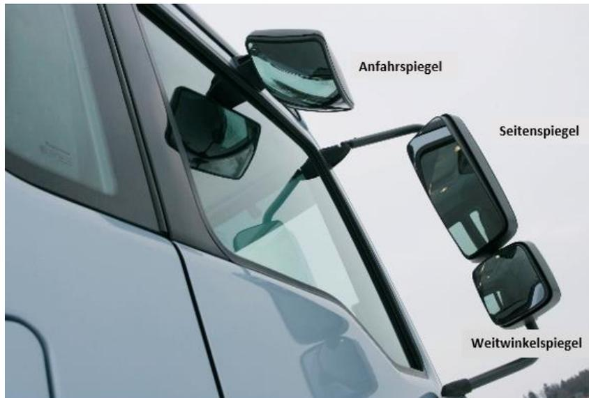
Abbildung 11: Fahrzeugspiegel<sup>24</sup>
