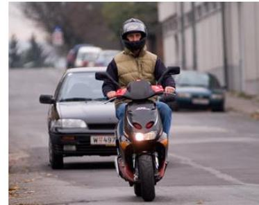
Abbildung 9: Abblendlicht oder Tagfahrleuchten für einspurige Kfz<sup>21</sup>
